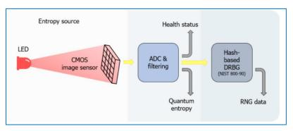
Figure 1 – Structure of IDQ6MC1 QRNG chip
