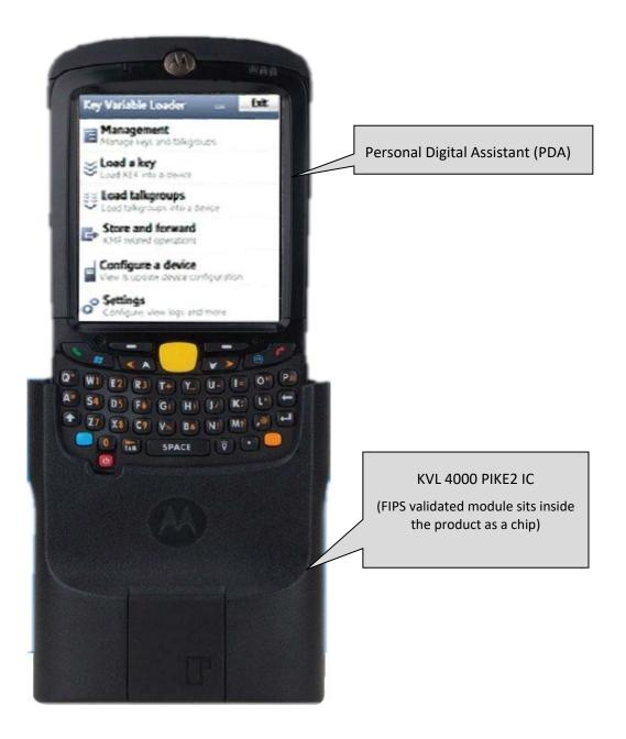
Figure 1: KVL 4000 Key Variable Loader (KVL)
